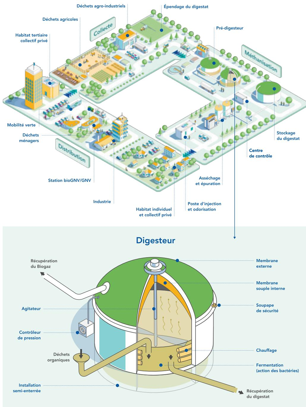
Le biogaz est un gaz 100% renouvelable produit localement et issu de la fermentation anaérobique (méthanisation) de résidus agricoles, d'effluents d'élevage et de déchets des territoires. Après épuration, il atteint le même niveau de qualité que le gaz naturel et peut donc être injecté dans les réseaux et couvrir les besoins des clients en chauffage, cuisson, eau chaude sanitaire et carburant. On l'appelle alors biométhane. Utilisé comme car-
