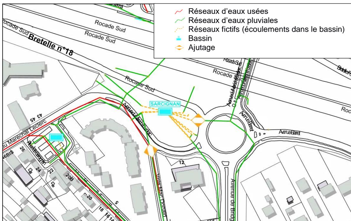
L'ouvrage présente 7 points d'entrée et est équipé d'un ouvrage de régulation calibré en sortie, d'un dégrilleur. En sortie de bassin, les eaux pluviales non infiltrées sont dirigées vers le collecteur d'eau pluvial DN400 du rond-point de l'avenue Barret.
