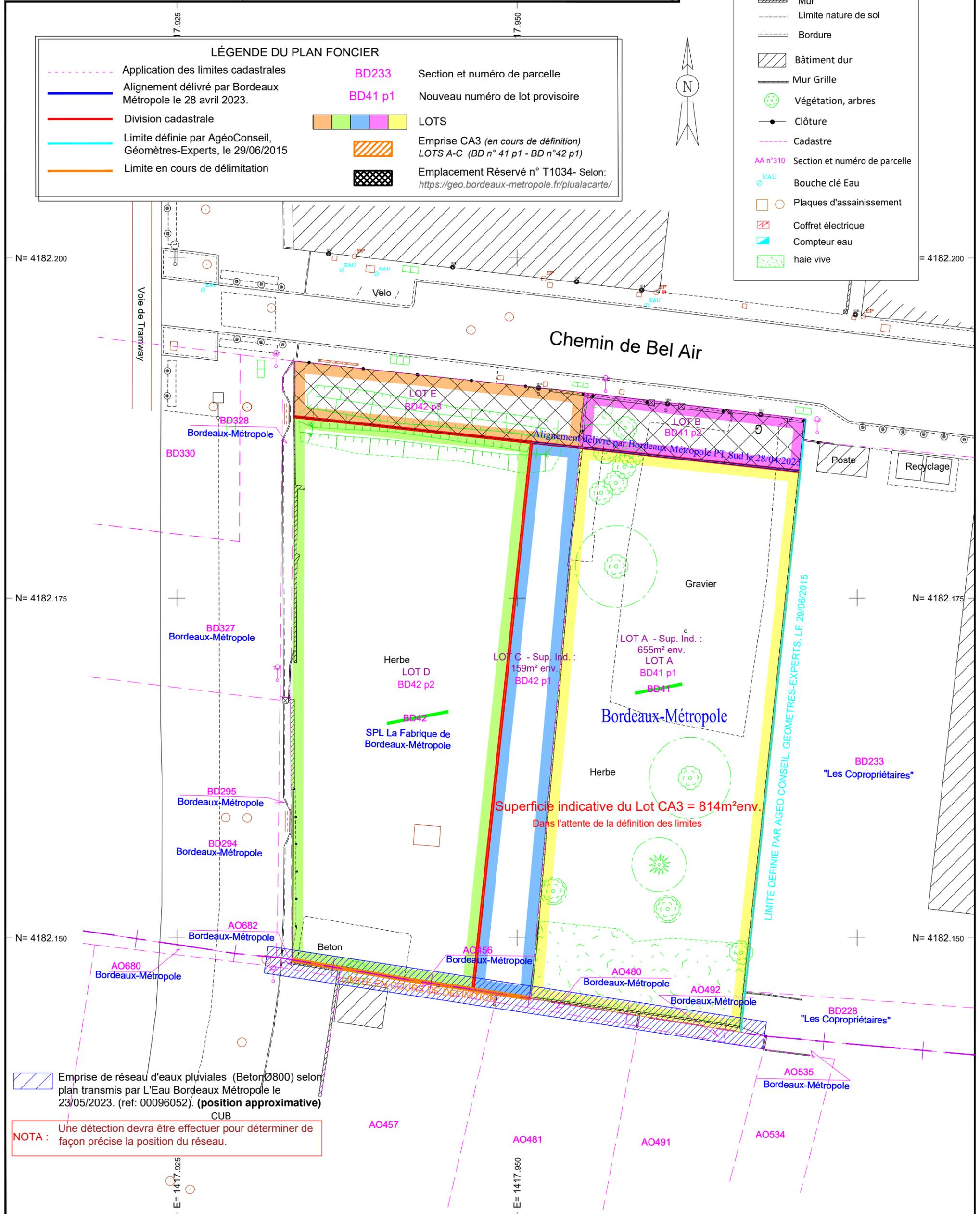
Emprise de réseau d'eaux pluviales (Béton Ø800) selon plan transmis par L'Eau Bordeaux Métropole le 23/05/2023. (ref: 00096052). (position approximative) CUB
