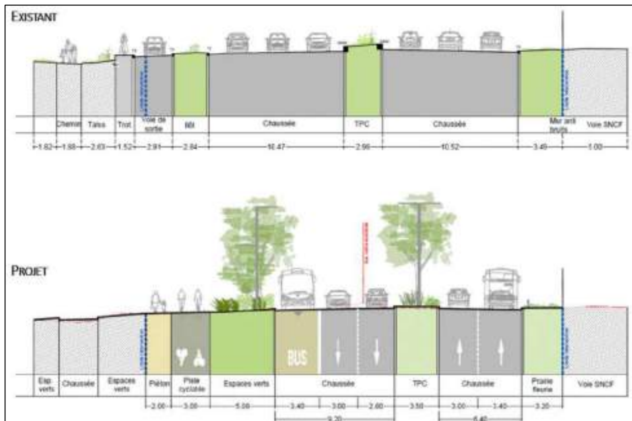
Coupe boulevard Joliot Curie requalifié au sud du centre commercial
