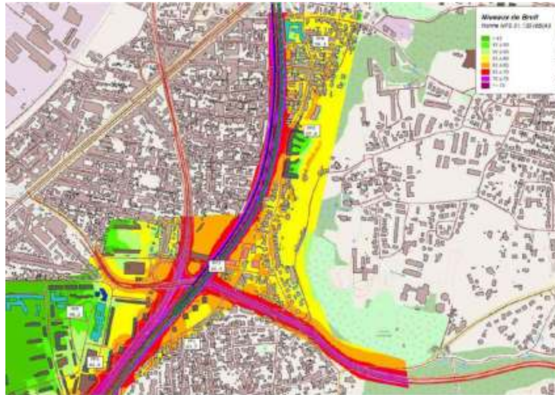
Figure 13 : carte de bruit période nocturne en situation actuelle TMJA 2018 Joliot Curie Nord (hauteur au sol de 4 mètres)
