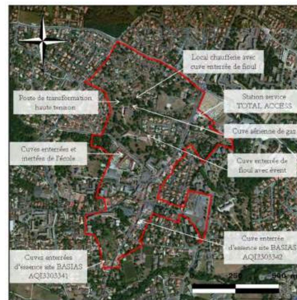
Figure 15 - Localisation des sources potentielles de pollution (source : prédiagnostic de pollution des sols par TERE0, juillet 2015)
