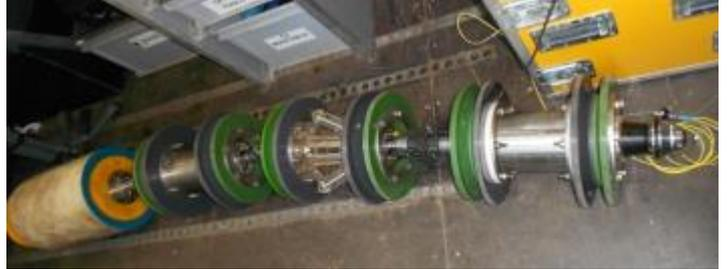
Figure 19: Furet pour inspection par ultrasons
