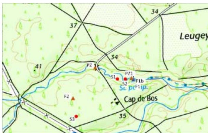
Deux ouvrages permettent l'exploitation des nappes Miocène et Oligocène avec respectivement le forage F1 bis (17 m de profondeur) et le forage F1 (155 m de profondeur).
