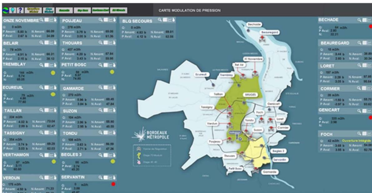
La télétransmission des données en GPRS au pas de temps du quart d'heure permet au contrôle centralisé Ausone d'assurer une meilleure gestion de la modulation de pression par l'envoi de télécommandes depuis l'écran de contrôle.
