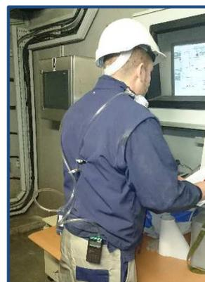
*Opérateur équipé de pompes de prélèvement d'air ambiant pendant l'étude de mesure des poussières et bio-aérosols*
