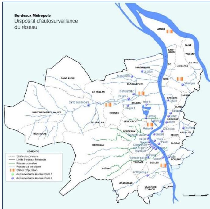
En complément des points autosurveillance réglementaires supplémentaires, Bordeaux Métropole a entrepris la réalisation, en deux phases, de surveillance d'autres points pour mieux caractériser les flux :
