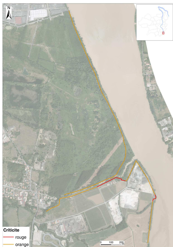
Figure 143 : Criticité des digues de Villenave d'Ornon - Source : Bordeaux Métropole - Etude de dangers des digues de Villenave d'Ornon – 2014
