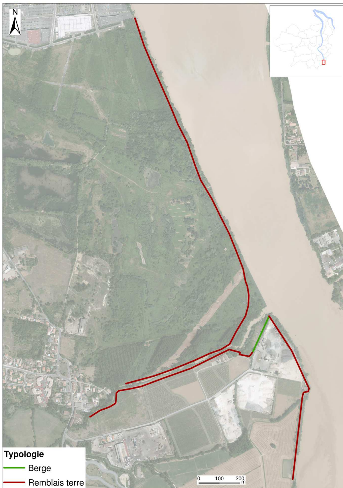
Figure 136 : Typologie des digues de Villenave d'Ornon- Source : Bordeaux Métropole - 2016
