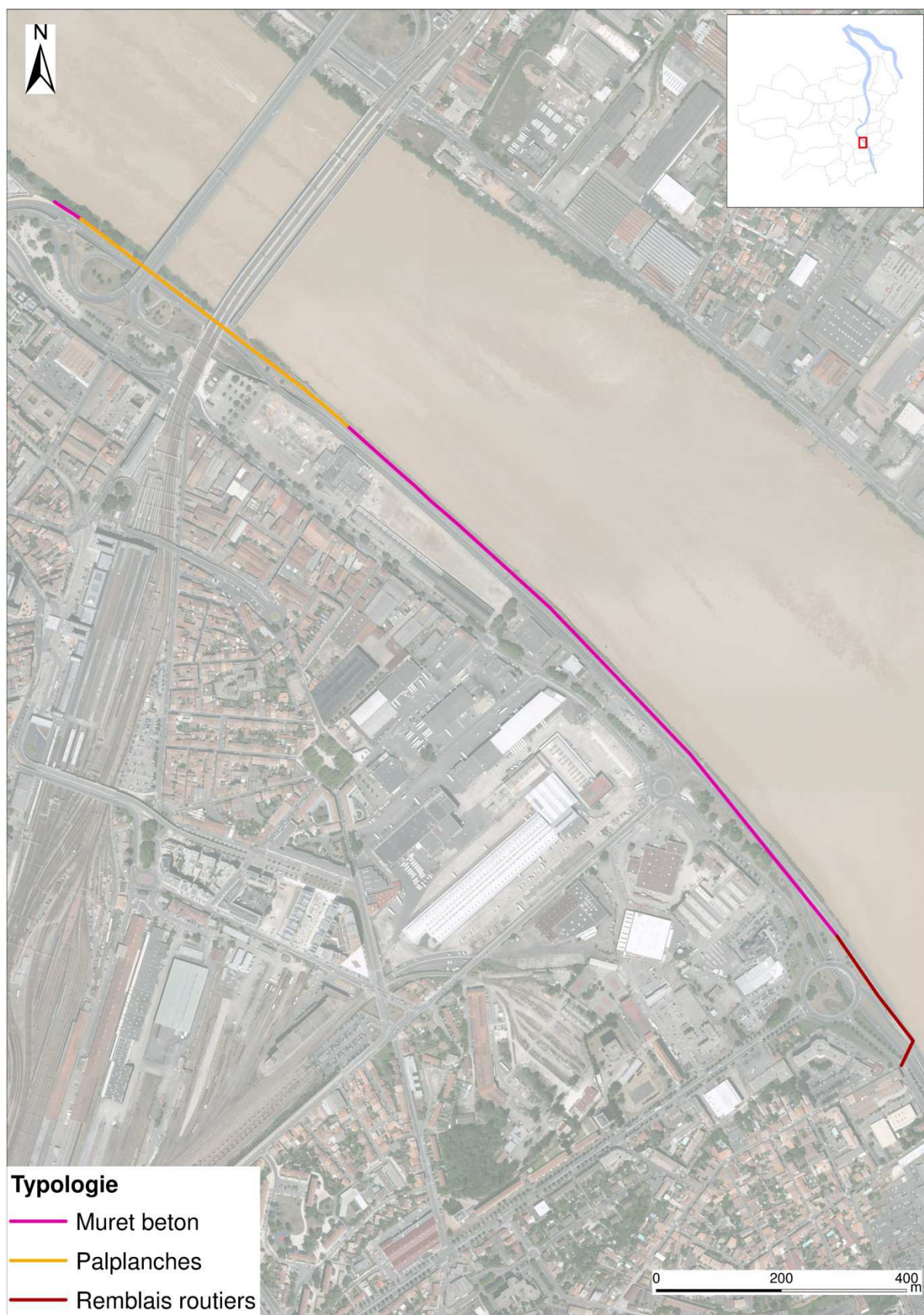
Figure 112 : Typologie de la digue de Saint-Jean Belcier - Source : Bordeaux Métropole - 2016
