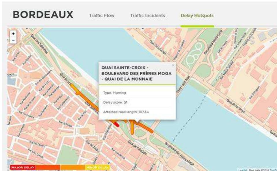
Les remontées des véhicules permettent de mettre en évidence les branches les plus sollicitées d'un carrefour, et d'ajuster ainsi la programmation en conséquence.
