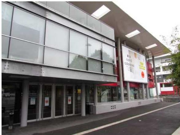
Les façades de la construction d'origine sont en béton enduit et panneaux de béton désactivé.
