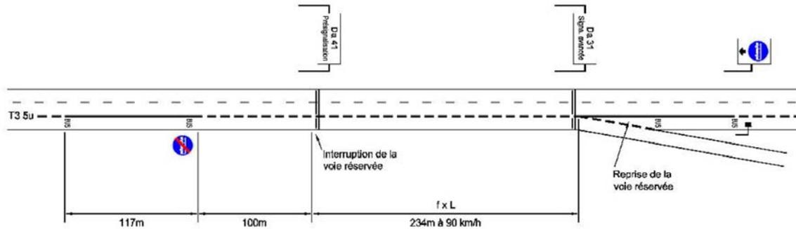
**Figure 6 : Interruption de la voie réservée en amont de la bretelle de sortie**
