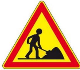
*L'utilisation seule de ce panneau (AK5) en amont de la zone d'intervention ne peut se faire que pour les chantiers de portée réduite (< 4m). Le conducteur de tramway adopte une vitesse de 10 km/h et reprend son allure dès que la zone de travail est dépassée par la cabine de conduite avant du tramway.*
