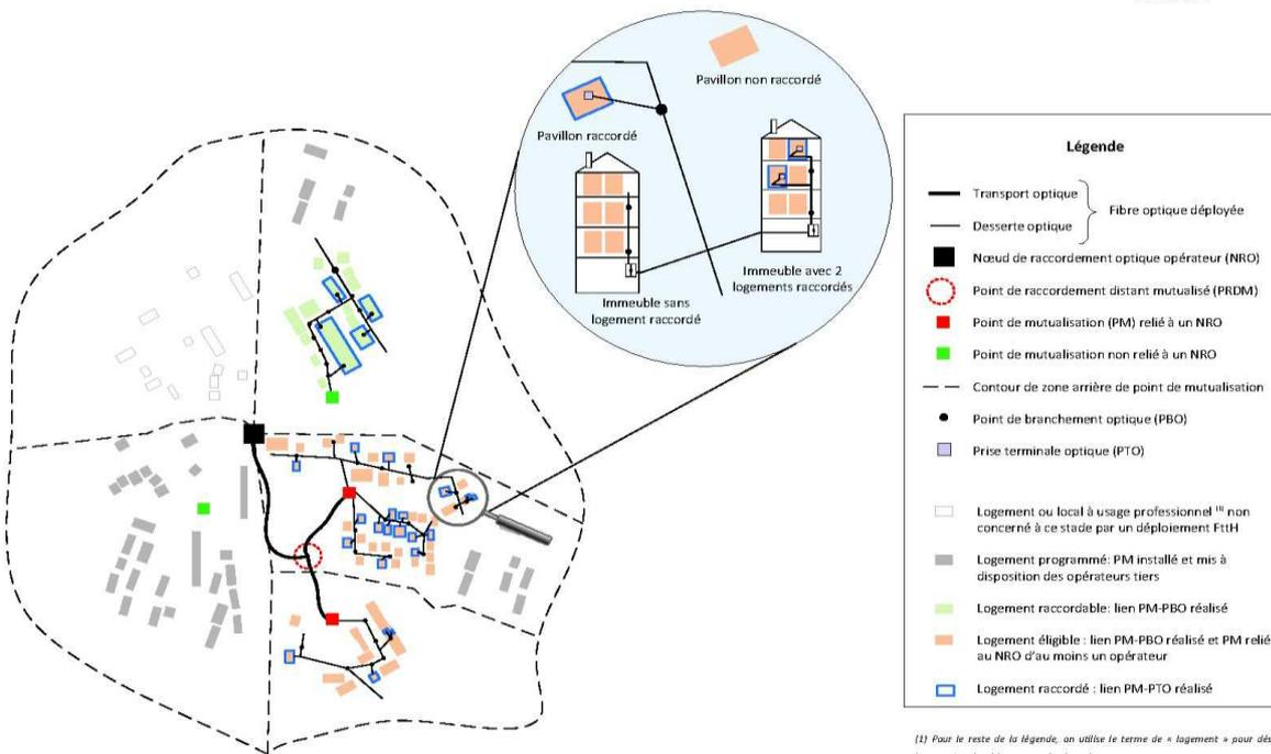
Déploiement de fibre optique jusqu'à l'abonné – Termes utilisés
