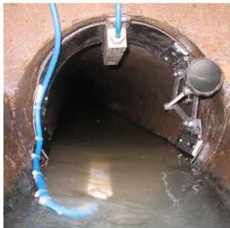
Une sonde doppler mesurant la vitesse de l'effluent est placée sur le radier juste en amont du regard. Cette sonde est accessible depuis le fond du regard. Cette mesure de vitesse est couplée à une mesure de hauteur intégrée à la sonde ou externe pour déterminer le débit.
