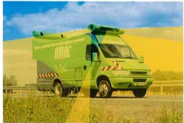
Appareil Multifonction d'Auscultation des Chaussées (AMAC® / VECTRA) enregistrement en continu des images fournies (tous les millimètres sur 3,9 mètres de large) par caméras numériques linéaires éclairées par des sources lasers + images d'environnement numériques hautes résolution (1280\*960).
