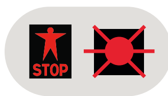
Arrêt absolu (feu clignotant rouge indiquant l'arrivée d'un tram)
