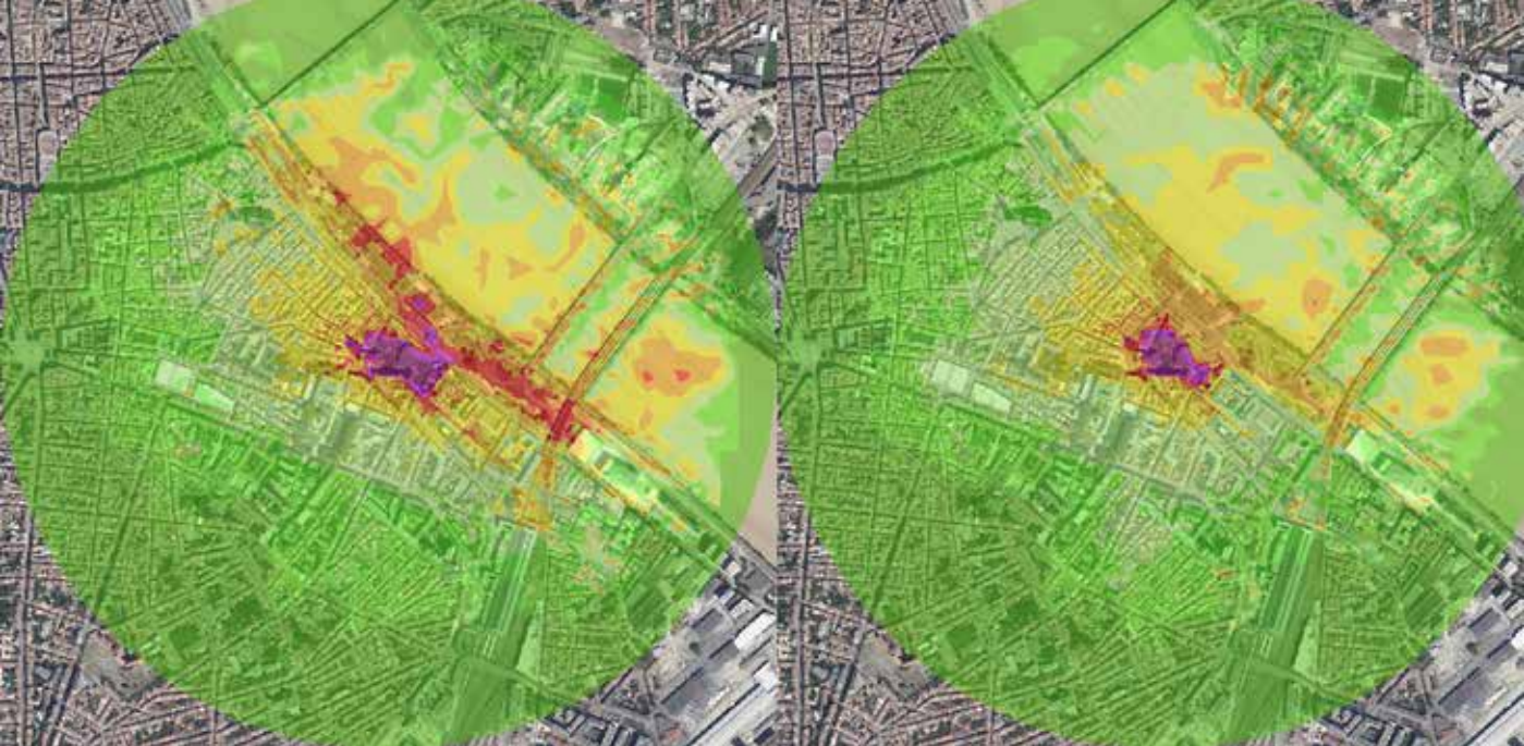
Cartes de l'impact sonore d'un festival de musique au square Dom Bedos sur les quartiers environnants, selon l'implantation des équipements de sonorisation. À gauche : situation initiale. À droite : simulation pour un scénario alternatif d'implantation.
